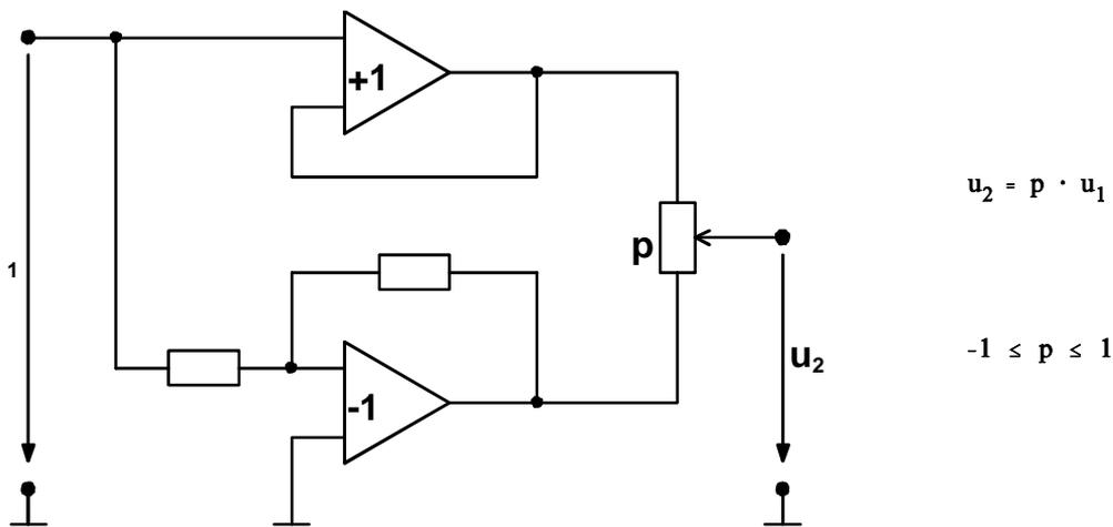
Bild 2.15 Koeffizientenbildung mit Verstärker und Umkehrverstärker
