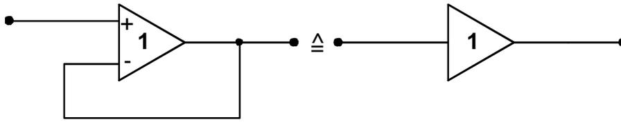
Bild 2.9 Spannungsfollower
