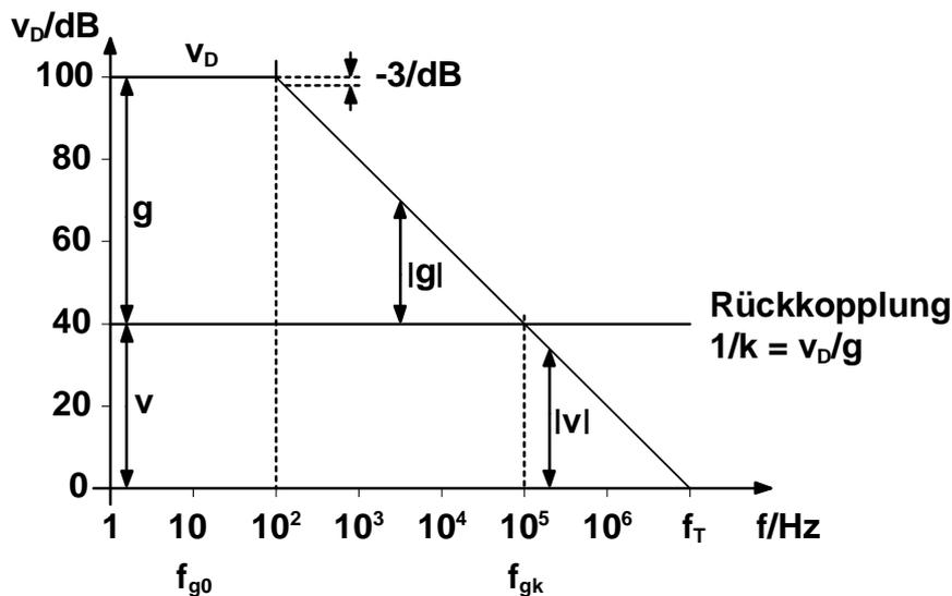
Bild 2.4 Bandbreite der Verstärkung bei Gegenkopplung
