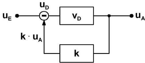
Bild 2.2 Verstärker mit Rückkopplung
