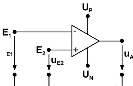
Bild 2.1 Symbol des Operationsverstärkers
