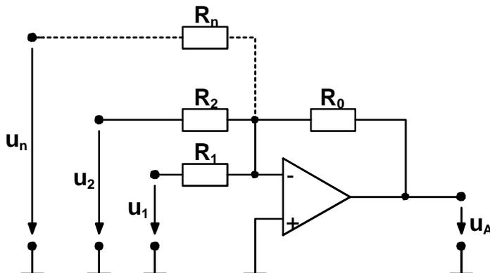
Bild 2.12 Addierer mit Signalumkehr
