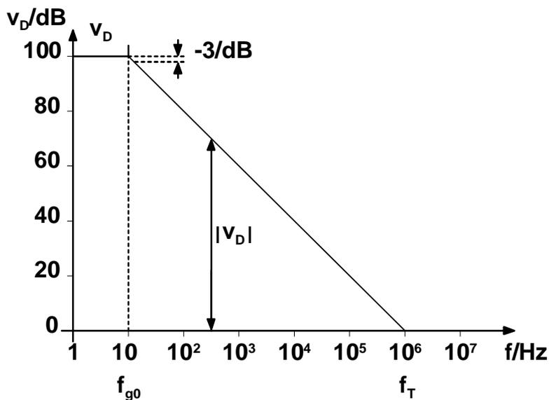
Bild 2.3 Frequenzgang eines Verstärkers mit einfachem Tiefpassverhalten
