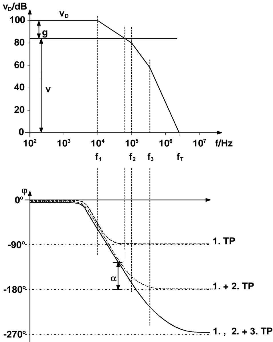
Bild 2.5 Bode-Diagramm der Verstärkung und des Phasengangs eines Operationsverstärkers
