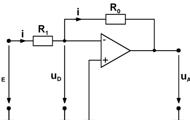
Bild 2.10 Invertierender Verstärker
