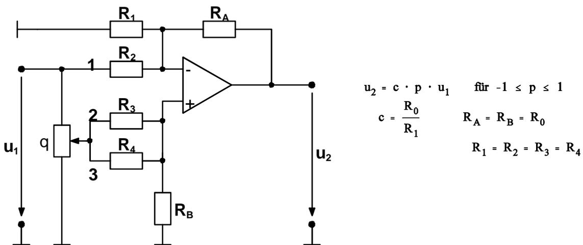
Bild 2.16 Koeffizienteneinstellung mit einem Verstärker
