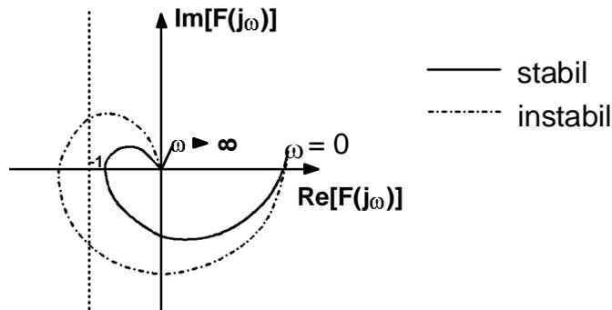
Bild 2.6 Ortskurve der Übertragungsfunktion
