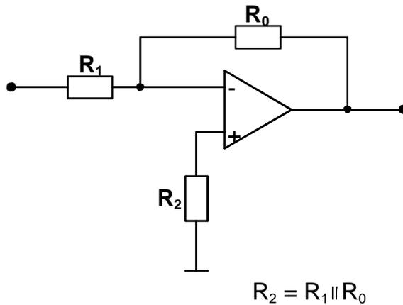
Bild 2.11 Invertierender Verstärker mit Kompensation des Offset-Stroms
