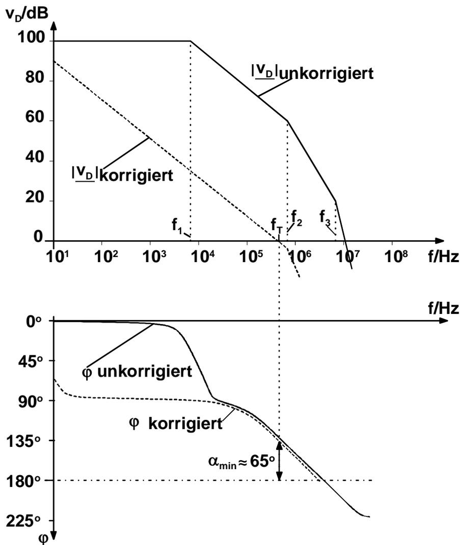
Bild 2.7 Beispiel für eine Korrektur des Frequenzganges
